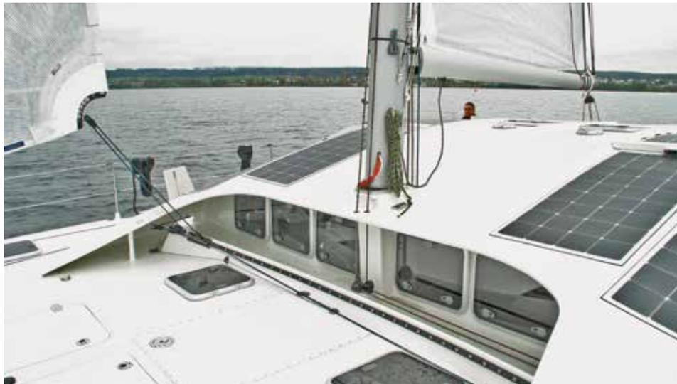
Das Deck ist geprägt von den begehbaren Solarzellen, den vielen großen Luken sowie der gut integrierten Selbstwendeschiene für die Rollfock.
