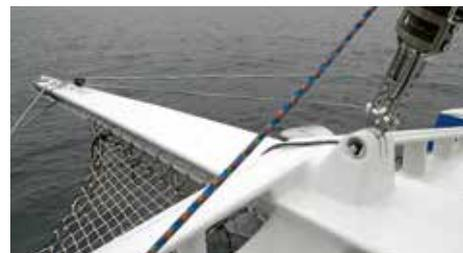
Der Beam ist aus Kohlefaser gefertigt. Die Vorstag-Laschung wurde aus rund 25 Lagen GFRK laminiert.
