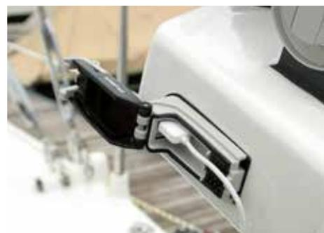
Wasserdichter USB-Anschluss an der Steuersäule.
