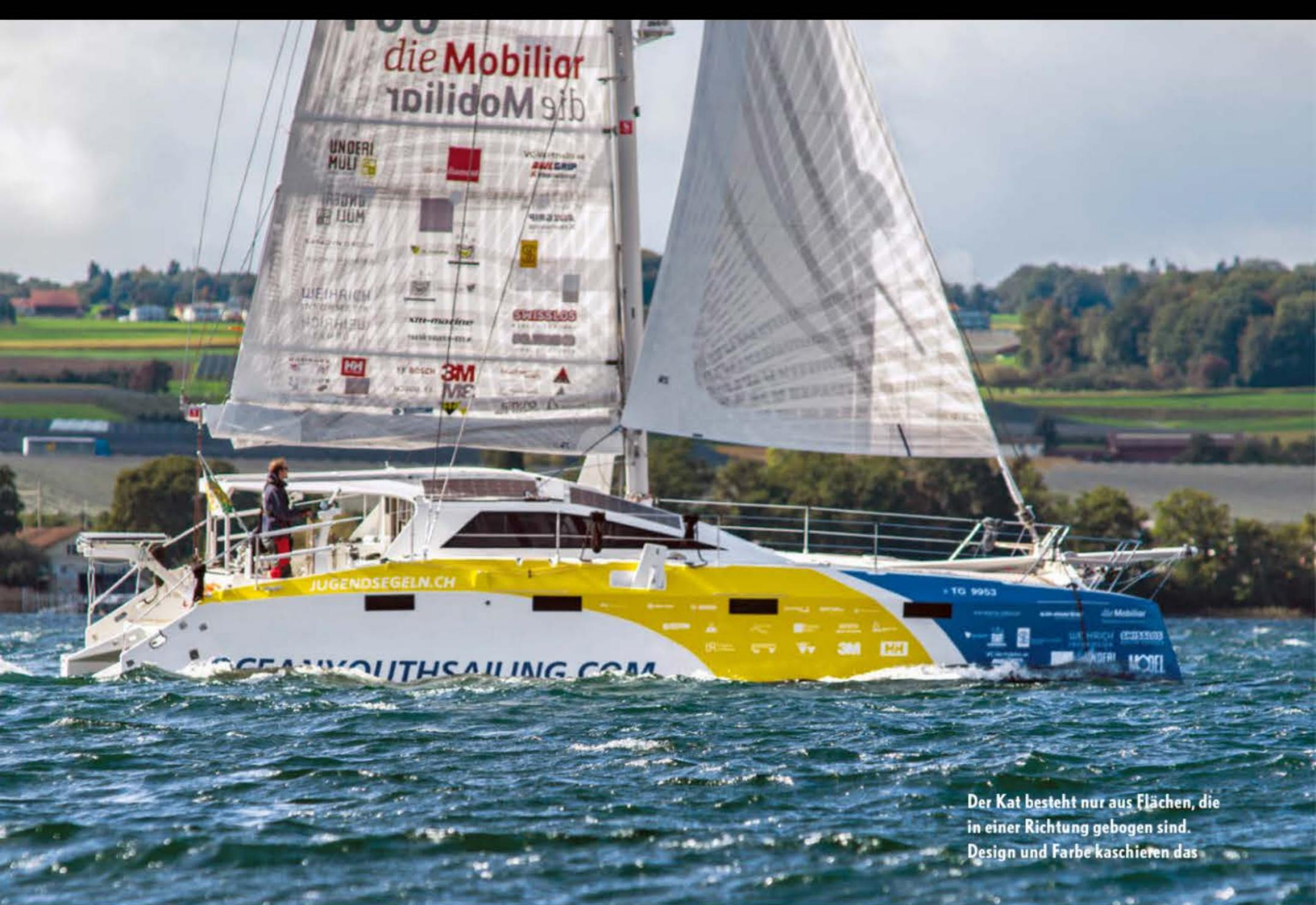
Der Kat besteht nur aus Flächen, die in einer Richtung gebogen sind. Design und Farbe kaschieren das
